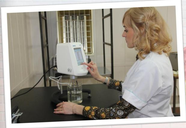
Средство измерений: Ротационный вискозиметр с диапазон вязкости, сП (мПа\*с) Мин.100 Макс. 40 000 000
