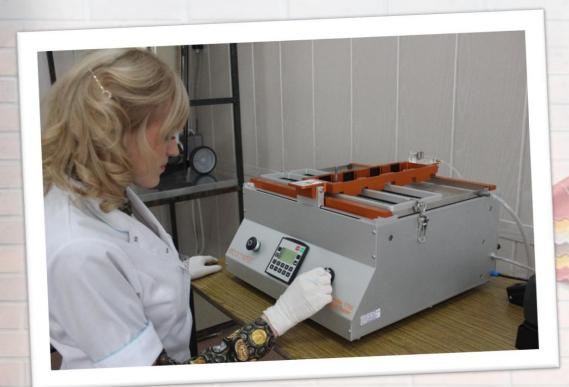
Определение стойкости к истиранию и очищению образцов прибором со следующими техническими параметрами:
