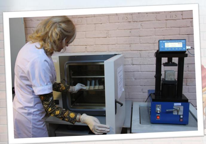
Тепловая обработка различных материалов и изделий осуществляются с помощью сушильного шкафа при температуре от 50°С до 350°С. Испытания проводятся в воздушной среде и в стационарных условиях.
