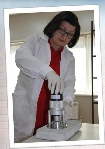
Измерение адгезионной прочности нанесенных покрытий к основанию (бетону)
