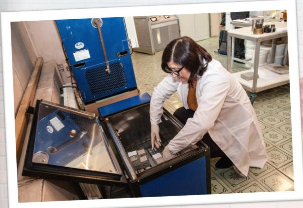
Ванна-термостат с диапазоном регулирования температуры от  $0^{\circ}$ C до  $+125^{\circ}$ C.
