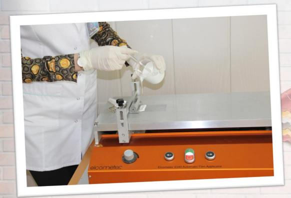
Автоматический аппликатор для ЛКМ Нанесение лакокрасочных материалов на различные основания, включая контрастные таблицы, листовую сталь, пластиковую пленку и стекло.
