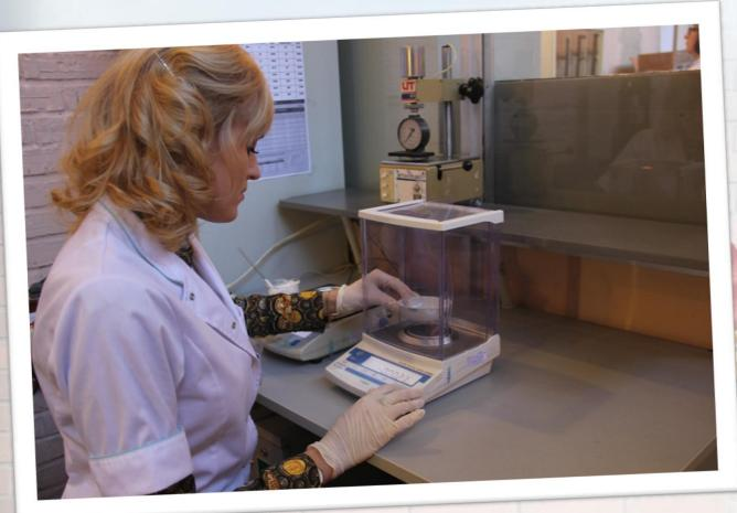
Средство измерений: Весы неавтоматического действия с диапазоном измерения: Мах220г., Міп0,01г.; Мах2200г., Міп0,5г.
